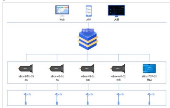
EPEVER RTU 2G A 一对一组网应用
